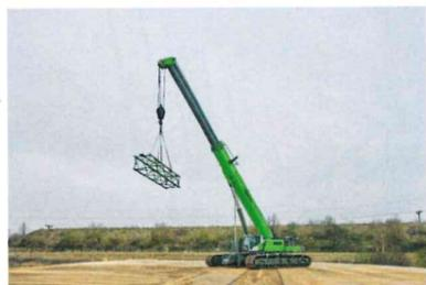
Les grues télescopiques sur chenilles offrent une alternative aux traditionnelles grues treillis sur chenilles pour les chantiers de construction. Plus souples dans leur utilisation, moins encombrantes, plus rapides à mettre en œuvre, plus faciles à transporter, elles permettent d'optimiser les opérations sur chantiers, d'accroître la sécurité et les coûts associés. Elles sont par ailleurs bien plus souples à l'utilisation que
