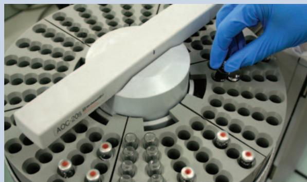
Le laboratoire d'analyses est dédié au suivi des lubrifiants en service, et donc en suivi après-vente. Il étudie de multiples échantillons de lubrifiants pour optimiser leur durée en service.
