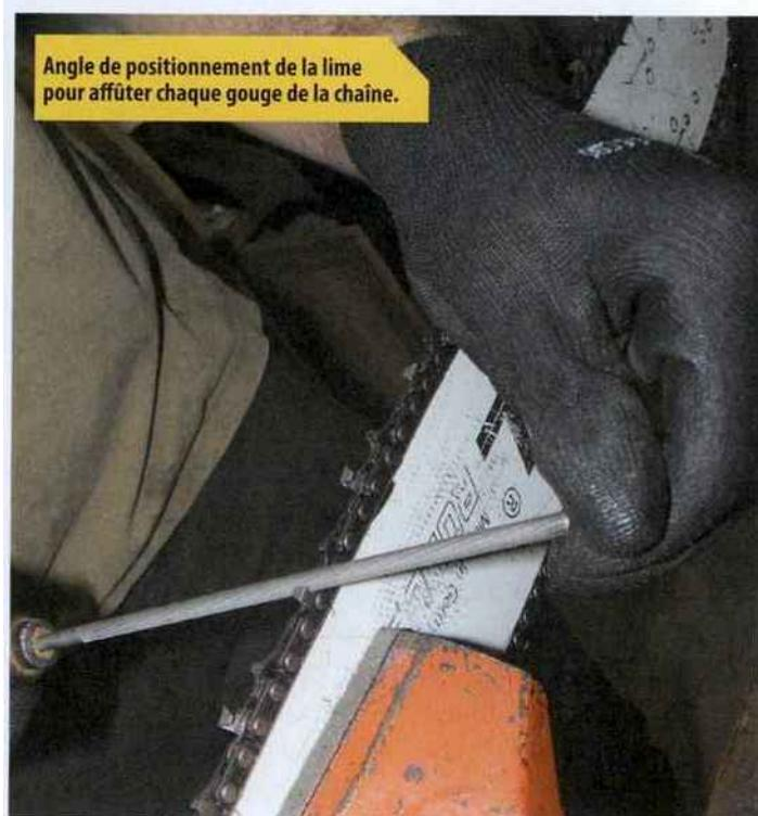
Angle de positionnement de la lime pour affûter chaque gouge de la chaîne.
