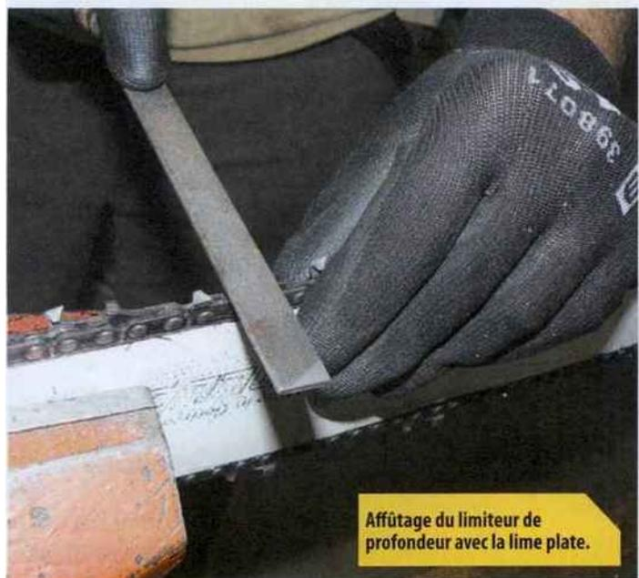
Affûtage du limiteur de profondeur avec la lime plate.
