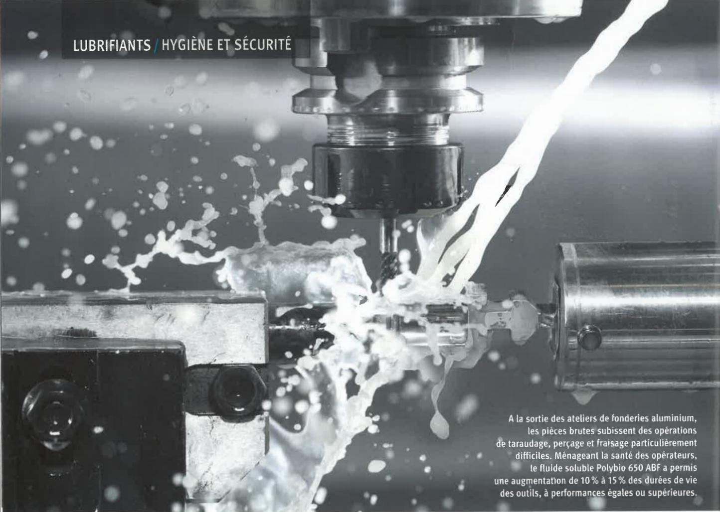
A la sortie des ateliers de fonderies aluminium, les pièces brutes subissent des opérations de taraudage, perçage et fraisage particulièrement difficiles. Ménageant la santé des opérateurs, le fluide soluble Polybio 650 ABF a permis une augmentation de 10% à 15% des durées de vie des outils, à performances égales ou supérieures.
